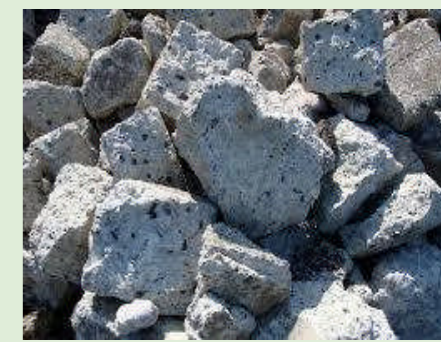
コンクリート廃材（無筋）
