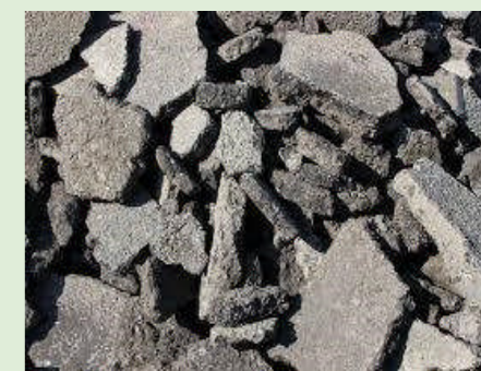
アスファルト廃材
